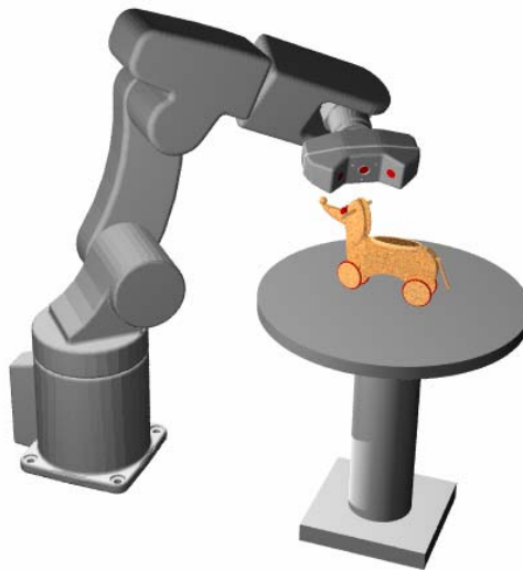
Fig. 3 – Sistemul de scanare, achizitie si aliniere cu scanner laser.
